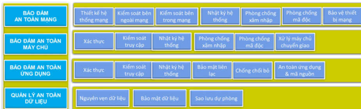
Hình 33 Mô hình yêu cầu kỹ thuật đảm bảo an toàn thông tin
